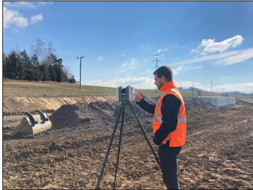
Obrázek 9 - Počáteční nastavení a seznámení s Leica RTC 360 [vlastní fotografie]
