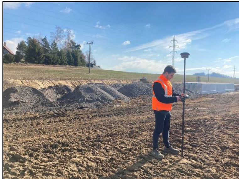
Obrázek 16 - Zkouška GNSS před zahájením měření [vlastní fotografie]
