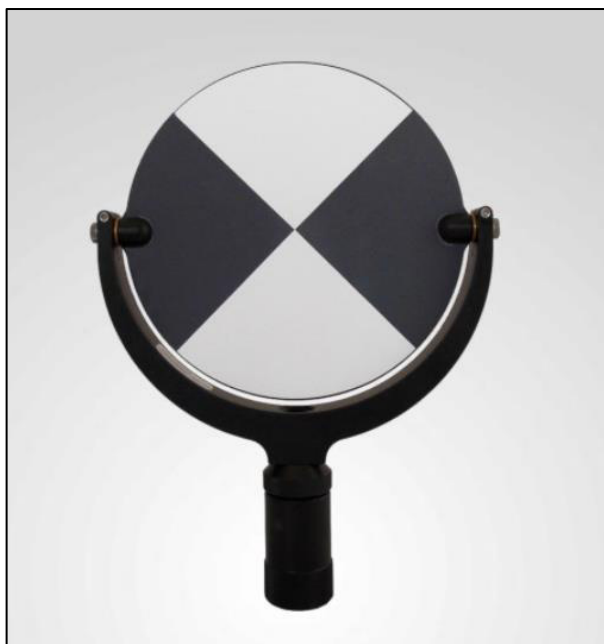
Obrázek 21 - Terč použitý pro metodu LS [23]
