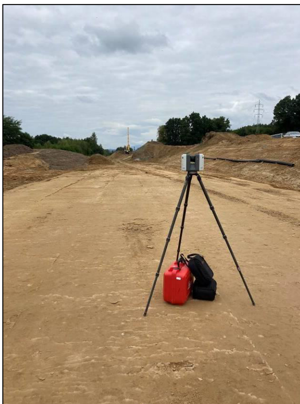
Obrázek 25 - 2. stanovisko při měření Leica RTC 360 [vlastní fotografie]
