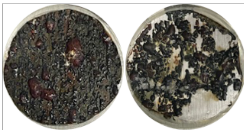
Obrázek 30 Projevy vzniku puchýřů u nátěrových filmů v závislosti na pH korozního prostředí; vlevo: LA při pH 4, vpravo: LA AAEM při pH 8
