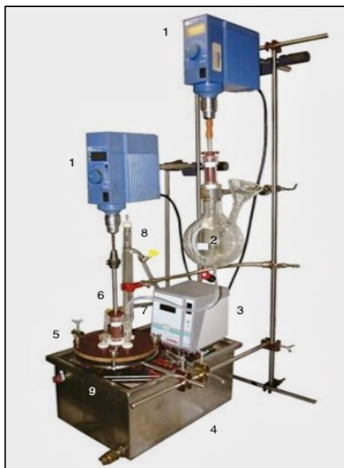
Obrázek 11 Aparatura k emulzní polymeraci, 1 – míchadlo, 2 – emulgační baňka, 3 – termostat, 4 – vodní lázeň s ohřívacím tělesem, 5 – těsnící kryt na polymerační reaktor, 6 – přívod inertního plynu, 7 – přívod monomerů, 8 – zpětný chladič, 9 – polymerační reaktor; převzato a upraveno z [65]
