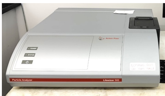
Obrázek 15 Přístroj Litesizer 500 používaný ke stanovení velikosti částic a Zeta potenciálu
