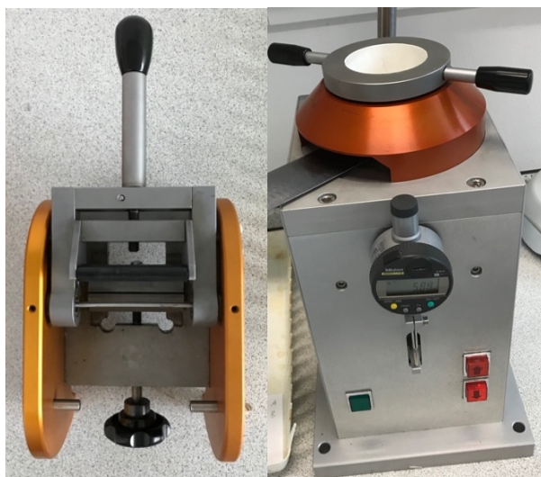
Obrázek 18 Vlevo přístroj Elcometer k testování odolnosti nátěru vůči ohybu; vpravo Erichsenův přístroj k testování odolnosti nátěru vůči hloubení
