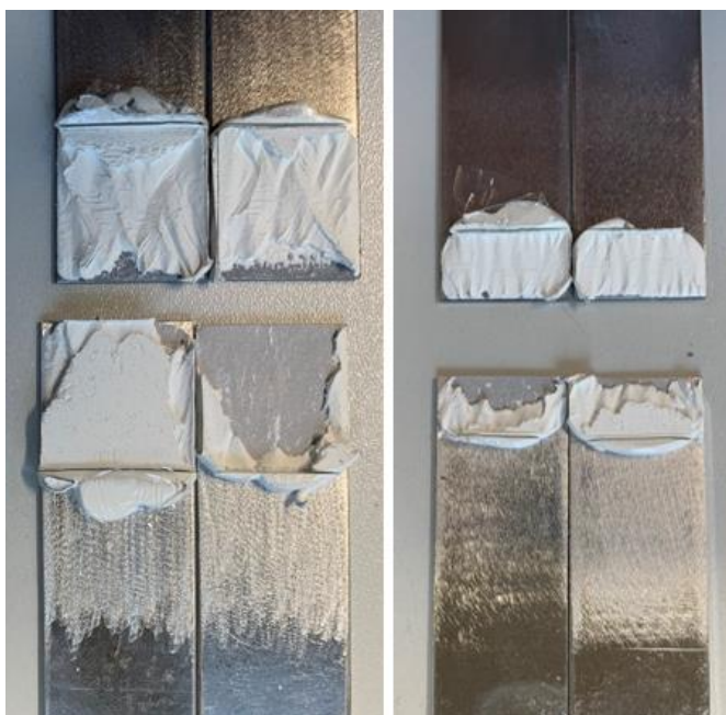
Obrázek 46: Porušení lepených spojů u lepidla Kömmerling Körapop 225
