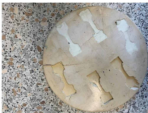
Obrázek 32: Silikonová forma po odlití tělísek
