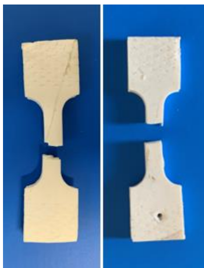
Obrázek 55: Přetržená tělíska při měření v tahu u lepidla Bison Grizzly Montage Extreme White
