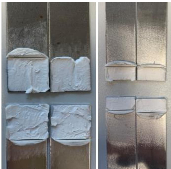
Obrázek 44: Porušení lepených spojů u lepidla Den Braven Mamut Glue High Tack
