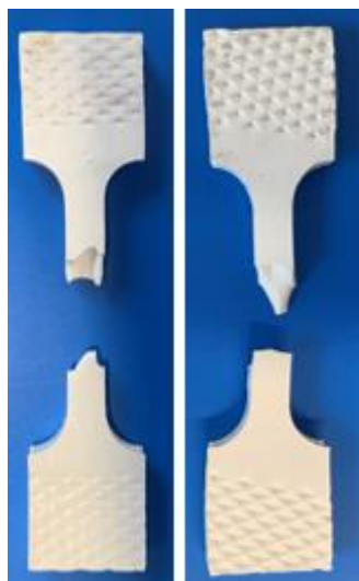
Obrázek 53: Přetržená tělíska při měření v tahu u lepidla Kömmerling Körapop 225-2 K
