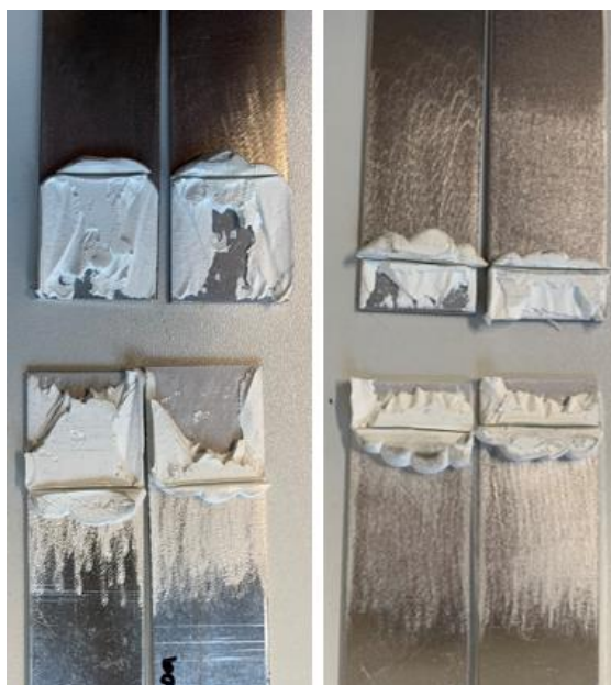
Obrázek 47: Porušení lepených spojů u lepidla Kömmerling Körapop 225-2 K
