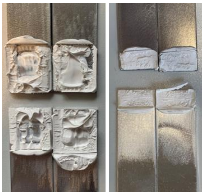
Obrázek 45: Porušení lepených spojů u lepidla 3M SMP Adhesive Sealant 760UV
