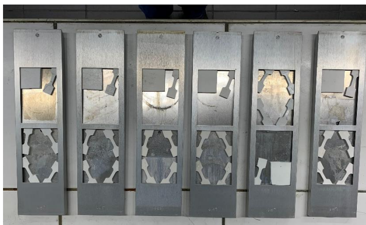
Obrázek 34: Vzorky pro urychlené UV stárnutí
