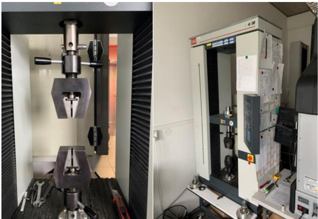
Obrázek 36: Trhací stroj MTS - 4/M a jeho čelisti (vlevo)
