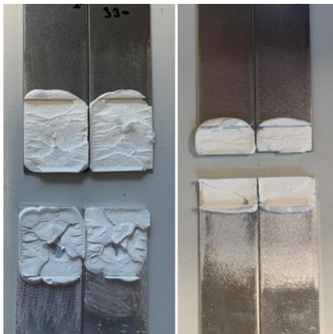
Obrázek 48: Porušení lepených spojů u lepidla Kömmerling Körapop 330
