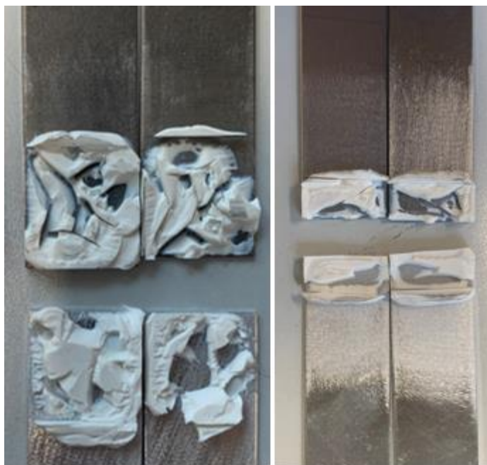
Obrázek 43: Porušení lepených spojů u lepidla Bison Grizzly Montage Extreme White
