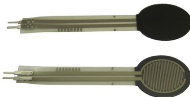
Obr. 3.1 – Piezorezistivní hmatový senzor (FSR402, 2010)
