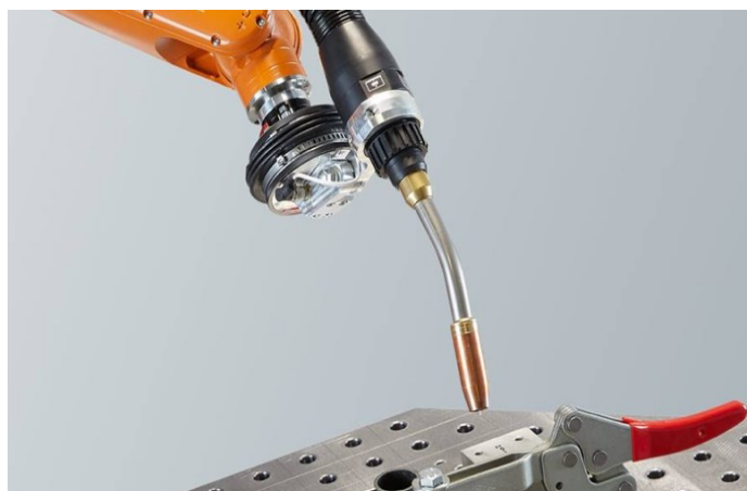
Obr. 1.1 – Hlavice pro obloukové svařování (KUKA ready2, 2022)
