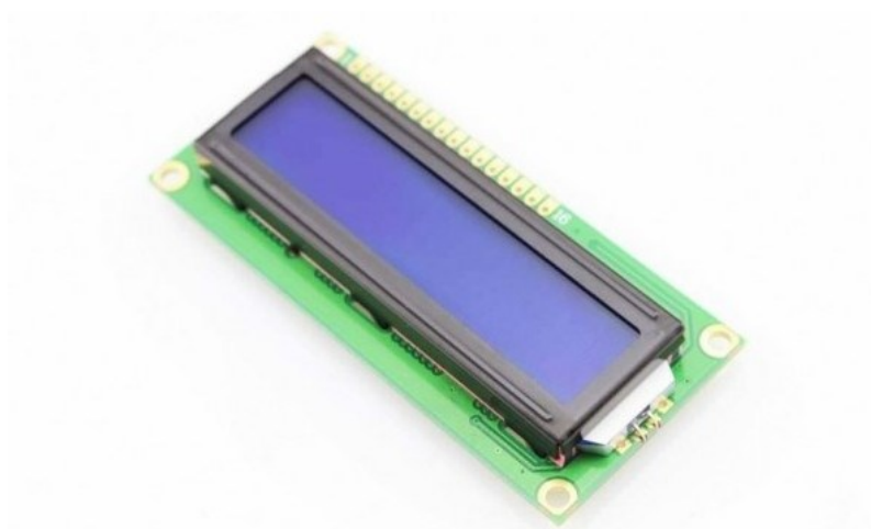
Obr. 5.9 – Displej pro Arduino (Arduino display modrý 16x2 znaků, nedatováno)
