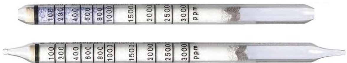
Obr. 2.1 – Měřicí trubice pro CO 2 (Vojáček, 2020)
