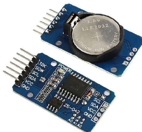
Obr. 5.8 – Obvod reálného času (DS3231 RTC module precise real time clock I2C AT2432C, nedatováno)
