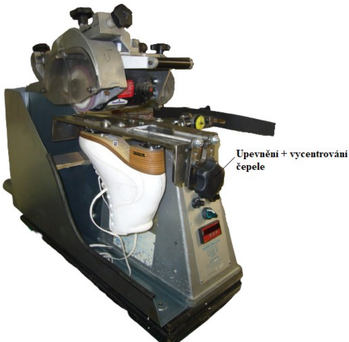
Obr. 2.3 – Ukázka stroje brusky s upevněnou bruslí
