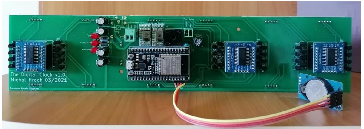
Obr. 4.9 – Vyleptaný a osazený plošný spoj
