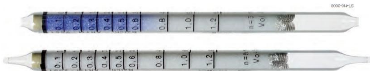
Obr. 2.1 – Měřicí trubice koncentrace CO 2 , online, (Vojáček, 2020)
