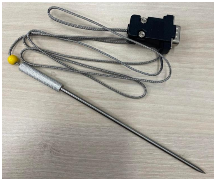
Obr. 7.30 Etalonový snímač PT1000
