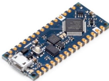
Obr. 7.2 Vývojový kit Arduino Nano Every [6]
