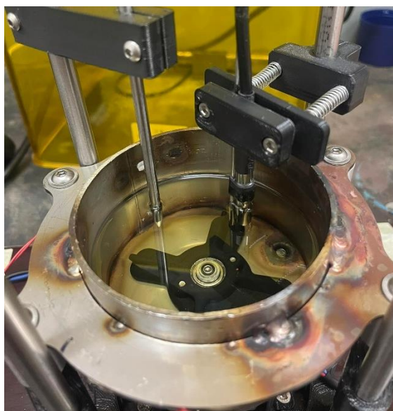
Obr. 11.13 Vzájemná poloha etalonu a DS18B20
