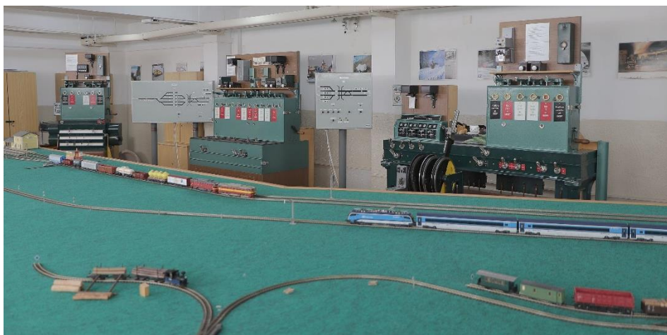
Obrázek 4 – elektromechanické zabezpečovací zařízení
