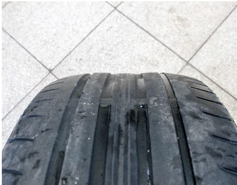
Obrázek 19 - Poškozená pneu č. 1 (19)
