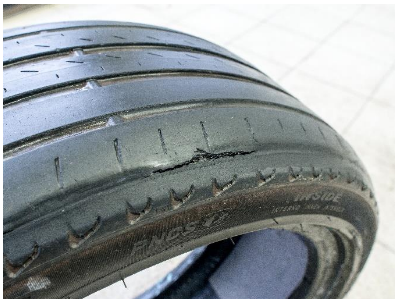
Obrázek 21 - Poškozená pneu č.3 (19)
