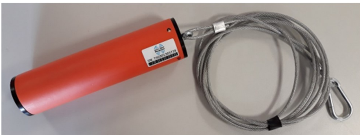
Obrázek 21 Bezdrátové AWB tlačítko (Škoda Auto, 2021a)
