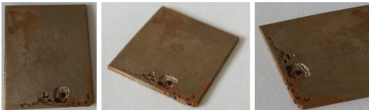
Obrázek 56: Povrchové poškození ocelových plíšků v důsledku korozních procesů
