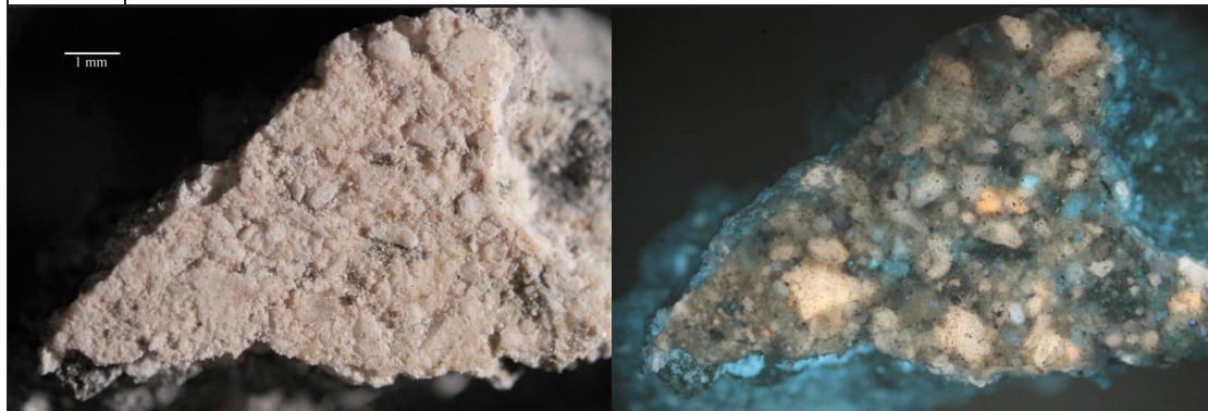
Obr. 32, 33 Optická mikroskopie, povrch vzorku, bílé světlo, UV fluorescence.
