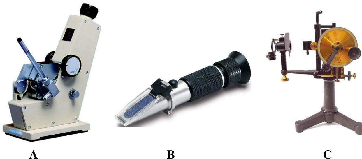
Obrázek 13 Tři vybrané nejpoužívanější refraktometry v kosmetické laboratorní praxi Abbého (A), ruční (B), Pulfrichův (C), [32-34]
