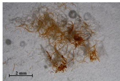
Makrosnímek vzorku TV2/9949 po reakci s roztokem chloridu železitého (vlevo) a makrosnímek standardu (vpravo). Fotografováno na stereomikroskopu SMZ800 (Nikon), bílé dopadající světlo, zvětšení na mikroskopu 10x.
