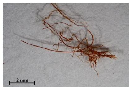
Makrosnímek vzorku TV1/9948 po reakci s roztokem chloridu železitého (vlevo) a makrosnímek standardu (vpravo). Fotožafováno na stereomikroskopu SMZ800 (Nikon), bílé dopadající světlo, zvětšení na mikroskopu 10x.
