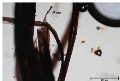
Snímek vláken vzorku TV5/9952 v Herbergově čínidle. Fotoграфováno na optickém mikroskopu Nikon ECLIPSE LV100 při zvětšení na mikroskopu 50x, 100x a 200xv bílém procházejícím světle.
