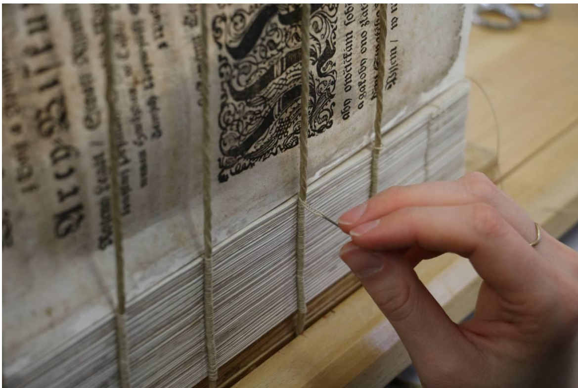
Obrázek 74 Šití knižního bloku na nové motouzové vazy
