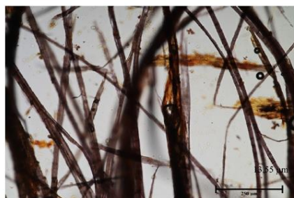
Snímek vláken vzorku TV4/9951 v Herbergově čínidle. Fotografováno na optickém mikroskopu Nikon ECLIPSE LV100 při zvětšení na mikroskopu 50x, 100x a 200x v bílém procházejícím světle.
