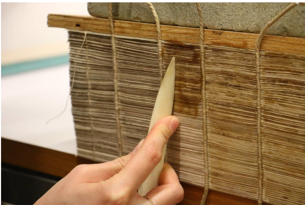
Obrázek 75 Klížení hřbetu knižního bloku
