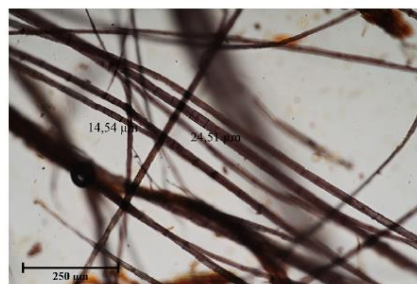
Snímek vláken vzorku TV4/9951 v Herbergově čínidle. Fotografováno na optickém mikroskopu Nikon ECLIPSE LV100 při zvětšení na mikroskopu 50x, 100x a 200x v bílém procházejícím světle.
