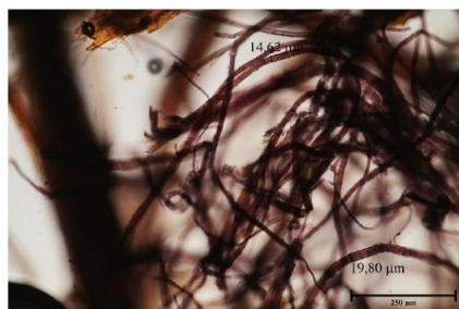
Snímek vláken vzorku TV6/9953 v Herbergově čínidle. Fotografováno na optickém mikroskopu Nikon ECLIPSE LV100 při zvětšení na mikroskopu 50x, 100x a 200x v bílém procházejícím světle.
