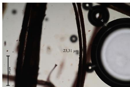
Snímek vláken vzorku TV5/9952 v Herbergově čínidle. Fotoграфováno na optickém mikroskopu Nikon ECLIPSE LV100 při zvětšení na mikroskopu 50x, 100x a 200xv bílém procházejícím světle.
