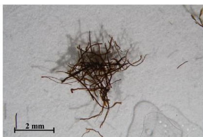
Makrosnímek vzorku TV1/9948 po reakci s roztokem chloridu železitého (vlevo) a makrosnímek standardu (vpravo). Fotožafováno na stereomikroskopu SMZ800 (Nikon), bílé dopadající světlo, zvětšení na mikroskopu 10x.
