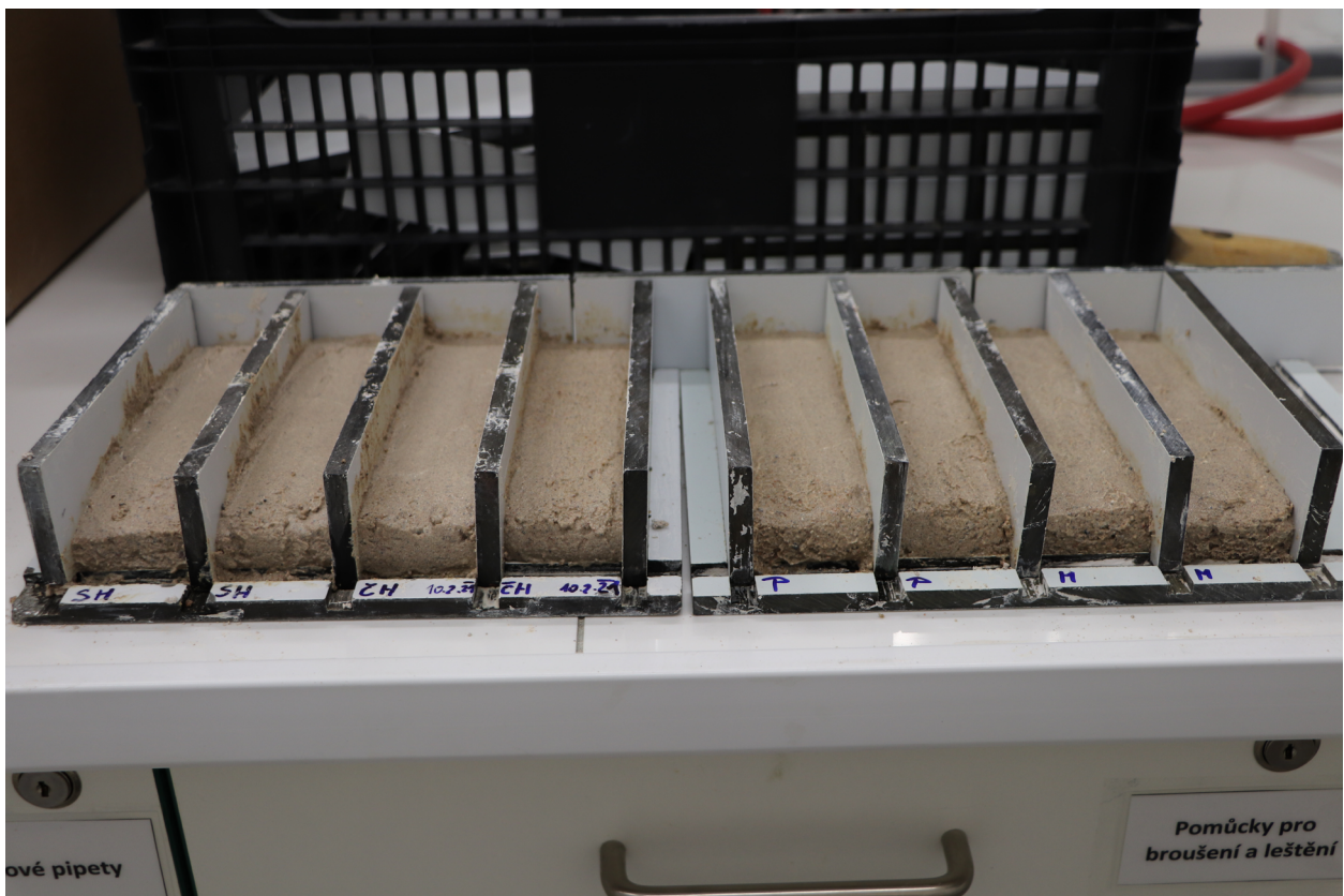
Obr. 09: Čerstvé malty po nanesení na anorganickou podložku. SH – suchý vápenný hydrát; ČH – čerstvý hydrát, po odležení 10 dnů; P – vápno Potštejn; M – vápno Makov.
