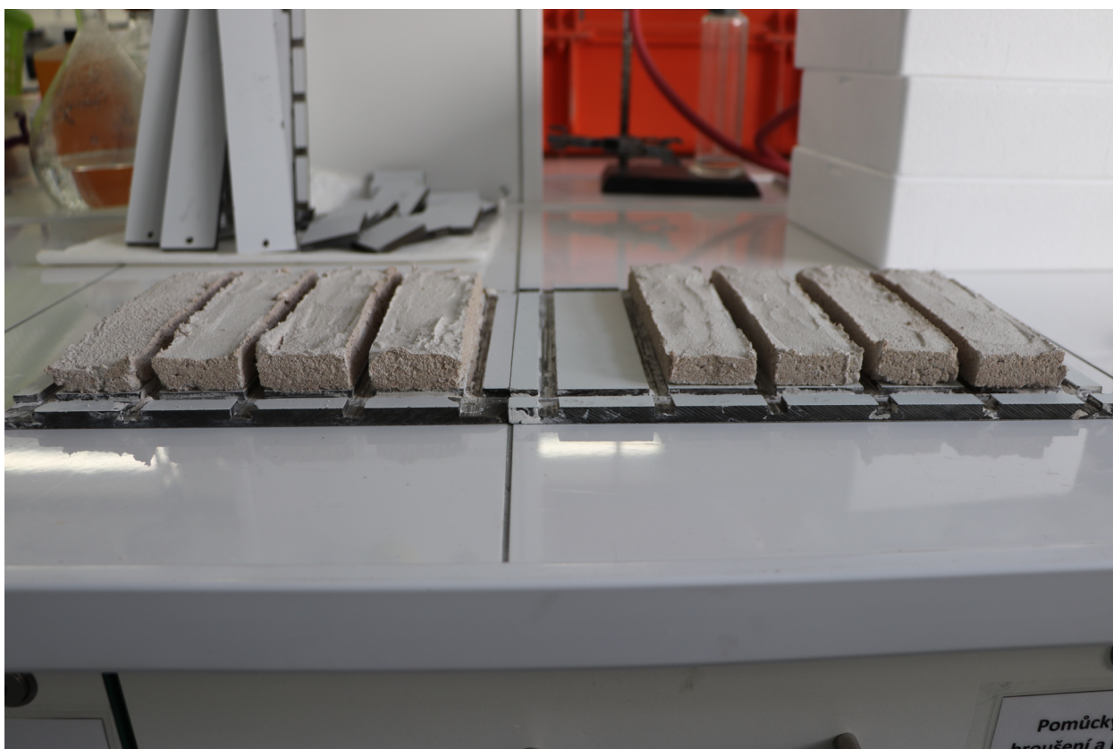
Obr. 11: Zkoušené malty po měsíci tvrdnutí. U žádných vzorků nejsou patrná výrazná smrštění ani praskliny. Pouze u druhého vzorku SH je viditelná jedna menší prasklina v pravém horním rohu.
