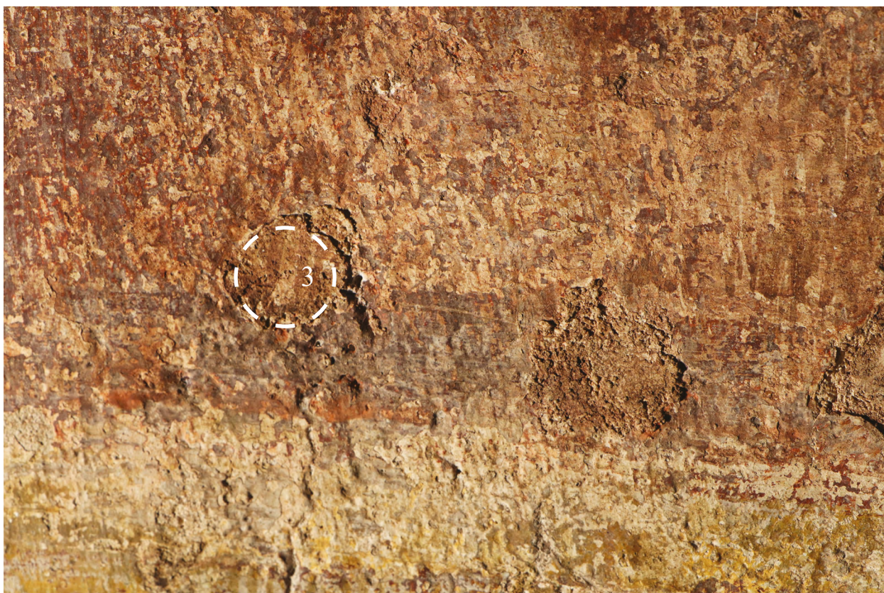
Obr. 30: Zkouška odstranění druhotných retuší na druhotných tmelech pomocí: 1) roztoku vody s lihem v objemovém poměru 1:1. Na některých místech byla zkouška úspěšná. Originální barevná vrstva nebyla narušena; 2) izopropylalkoholu. Výsledek byl mírně úspěšný.
