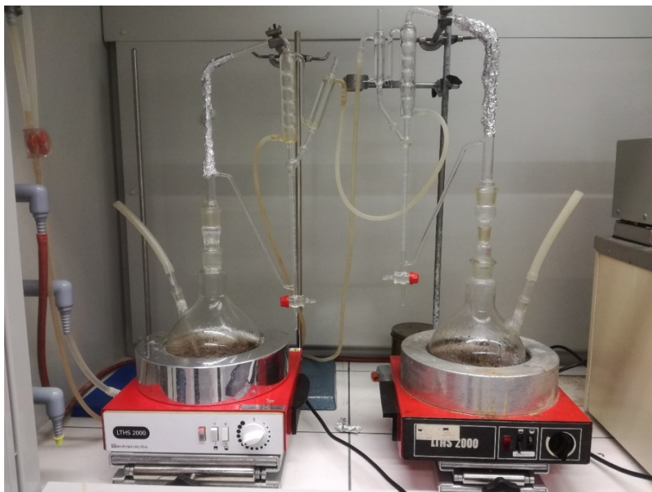
Obrázek 12 Aparatura využitá pro získání esenciálních olejů
