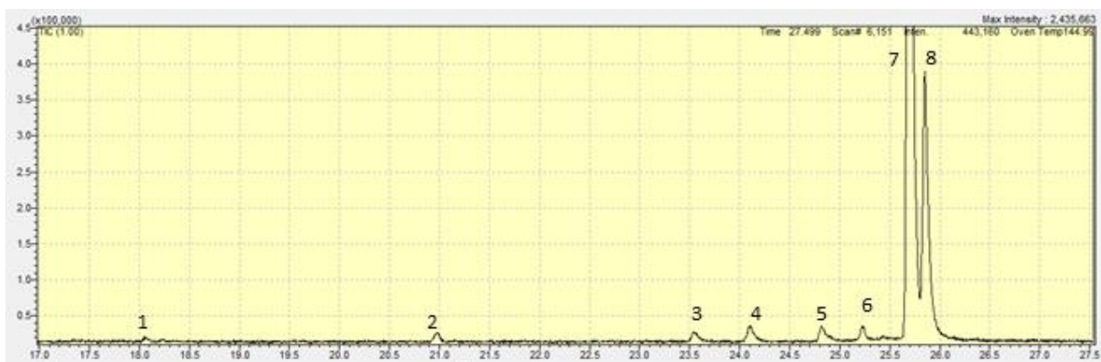
Chromatogram analýzy \alpha -terpineolu: extrakce kapalina-kapalina, zahřátí (20 min, 100 °C). 1: limonen, 2: terpinolen, 3: terpin-3-en-1-ol, 4: \delta -terpineol, 5: \beta -terpineol, 6: terpinen-4-ol, 7: \alpha -terpineol, 8: \gamma -terpineol
