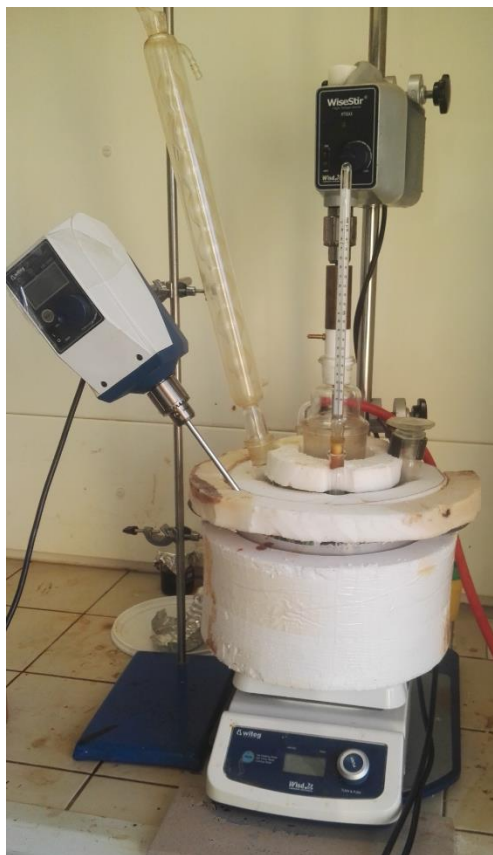
Obr. 8: Aparatura pro depolymeraci PUR pěn (míchaná olejová lázeň, vstup míchadla, inertního plynu, teploměru, zpětného chladiče a doplňování surovin)
