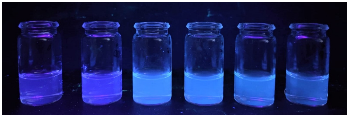
Obrázek 27 Roztok sloučeniny 46h, konc. 3 \cdot 10^{-5} M ve směsi DMF/voda, zleva rostoucí objemové množství H_2O : 0 %, 30 %, 50 %, 70 %, 90 %, 95 %.
