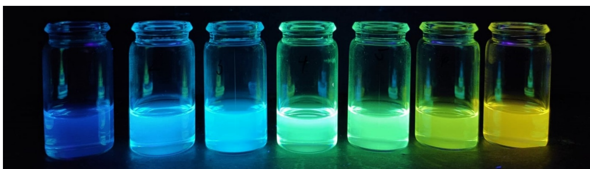
Obrázek 29 Solvatochromie sloučeniny 46c v řadě rozpouštědel, zleva cyklohexan, toluen, diethylether, chlorbenzen, tetrahydrofuran, chloroform a dichlormethan
