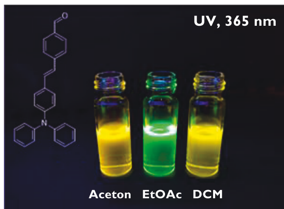
Obrázek 41 Solvatochromie molekuly 24 v acetonu, ethylacetátu a DCM při vlnové délce 365 nm.
