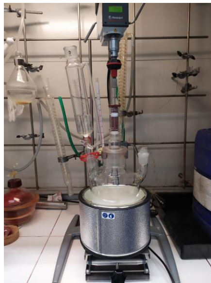
Obrázek 36 Aparatura s horním mícháním a kovovým míchadlem.
