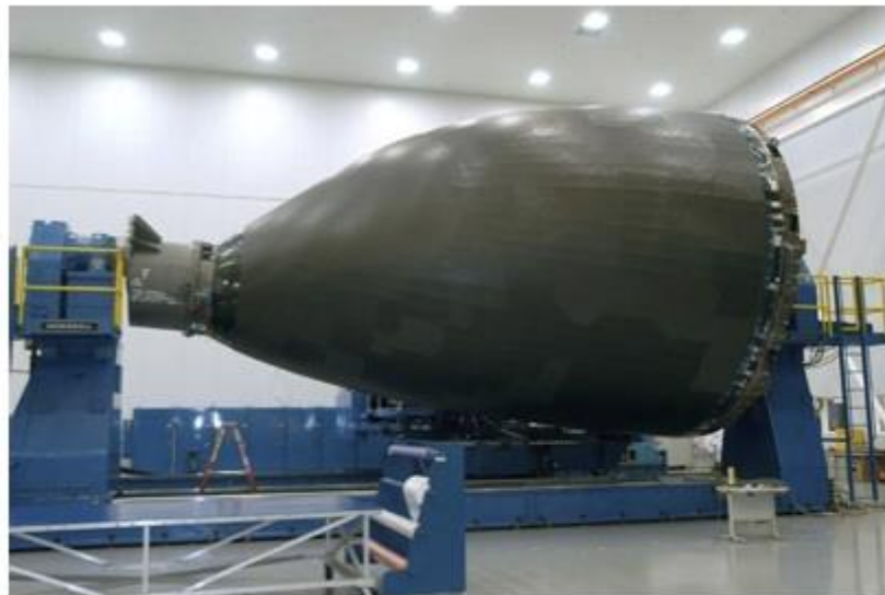
Obrázek 10: Ukázka navíjení části trupu 787 [15]
