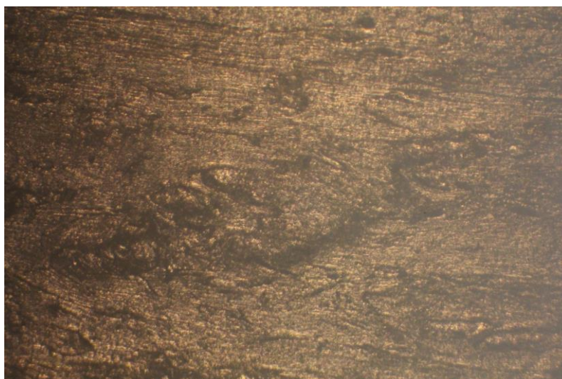
Obr. 51 Vzorek směs (rotomoulding) po 6 měsících v naftě
