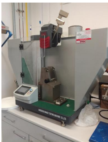
Obr. 36 Kyvadlové kladivo typu PIT 501J-3
