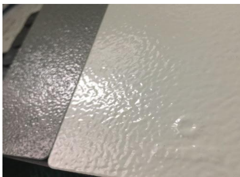
Obr. 22 Pomerančová kůra na povrchu polyethylenu [39]
