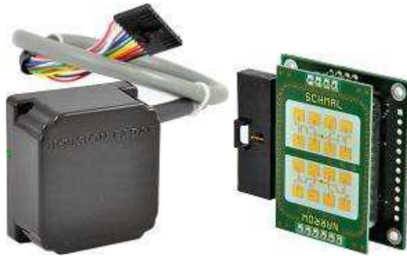
Obrázek 9: Měřič rychlosti SS 400 fy Houston Radar. Vlevo zapouzdřený, vprava bez pouzdra - jsou vidět plošné vysílací a přijímací antény.
