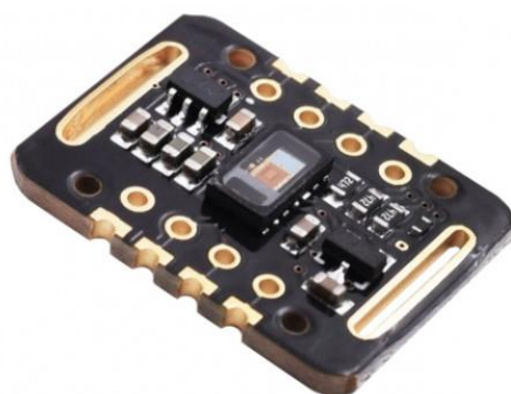
Obr. 2.8 – Pulzní oxymetr MAX30102 (MAX30102 Heart Rate Sensor, 2021)
