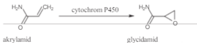
Obrázek 2 Přeměna akrylamidu v glycidamid (upraveno dle Joaquín et al. , 2019)
