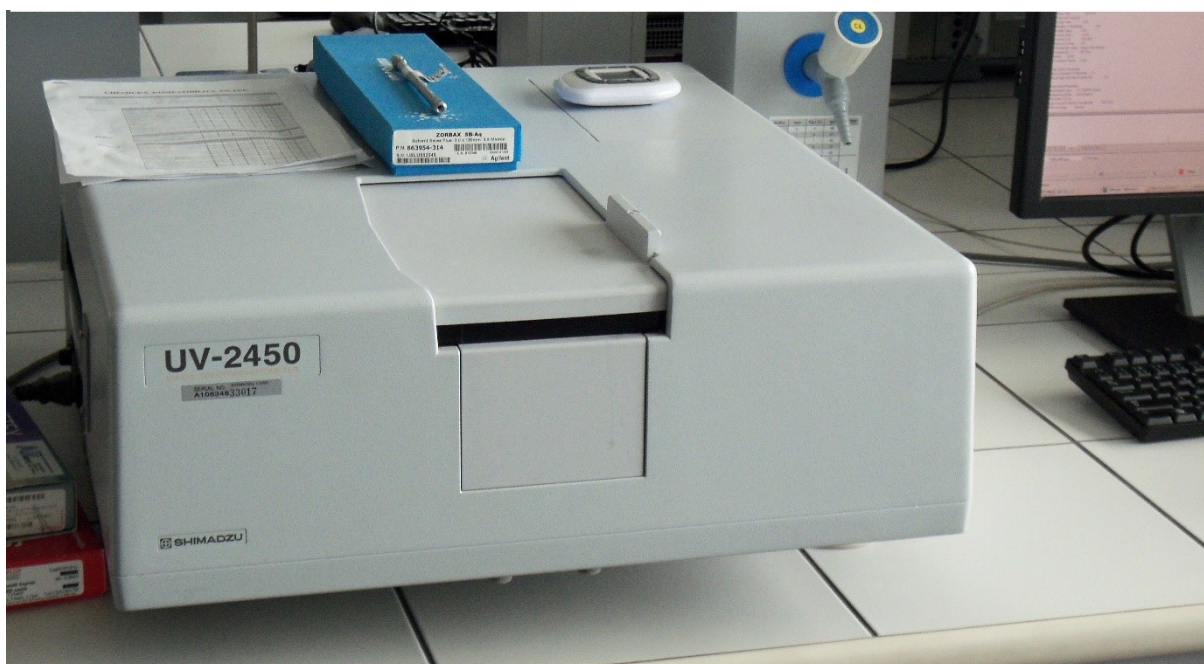
Obrázek 18: Měřicí přístroj Shimadzu UV-2450 UV-Vis Spektrofotometr
