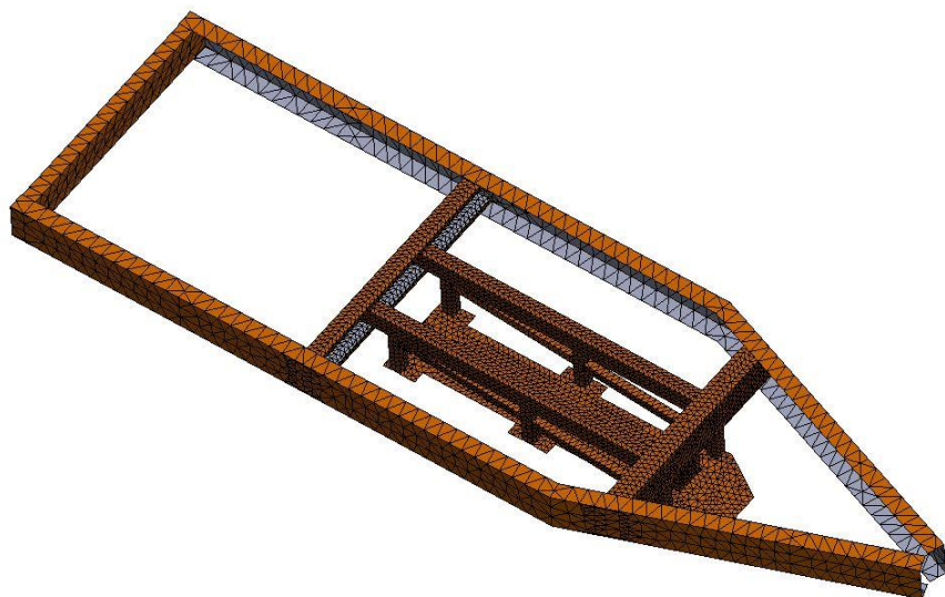
Obr. 57: Síť výpočtového modelu rámu mechanismu
