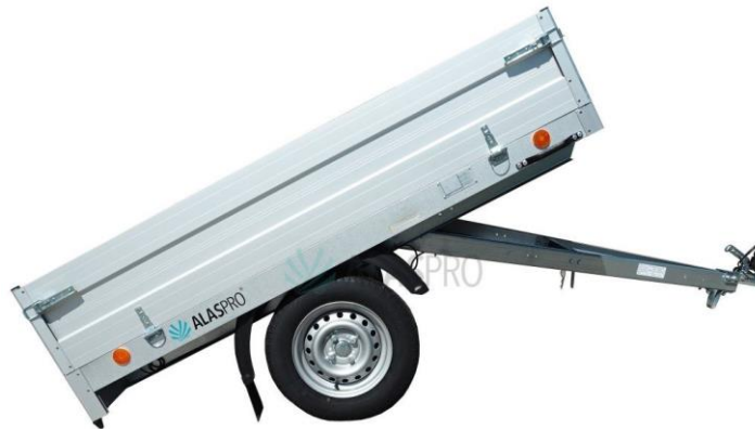
Obr. 6: Naklápěcí valník (zdroj [1])
