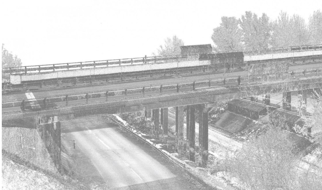
Obrázek 32: Ukázka výstupu statického pozemního skenování skenerem značky Riegl [21]
