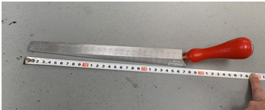
Obrázek 37: Použitý měřicí klínek MK27 [vlastní fotografie]
