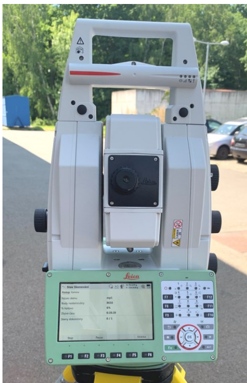
Obrázek 42: Multistanice MS60 - Leica [vlastní fotografie]
