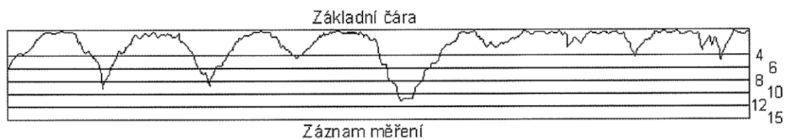
Obrázek 8: Příklad viagramu mechanického záznamu podélných nerovností povrchu [2]
