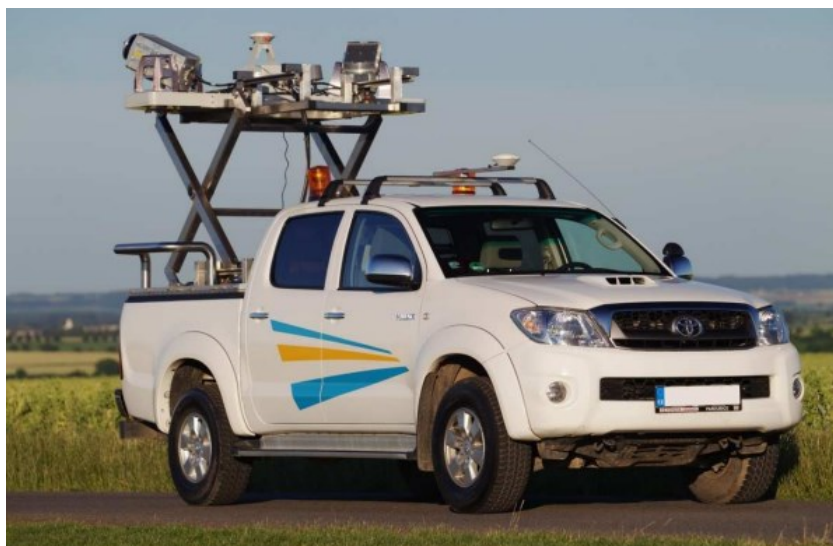
Obrázek 22: Příklad pozemního laserového skenování [19]
