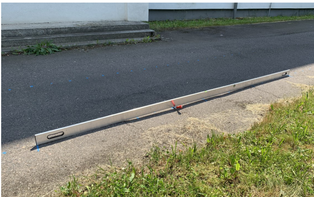
Obrázek 53: Průběh měření nerovností latí - zkušební úsek č. 2 [vlastní fotografie]
