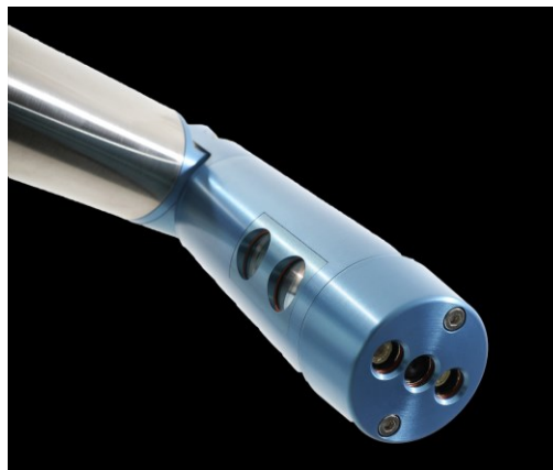
Obrázek 28: Přístroj CARLSON C-ALS pro průzkum podzemních dutin [28]
