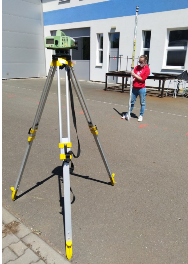
Obrázek 55: Průběh měření – přesná nivelace [vlastní fotografie]
