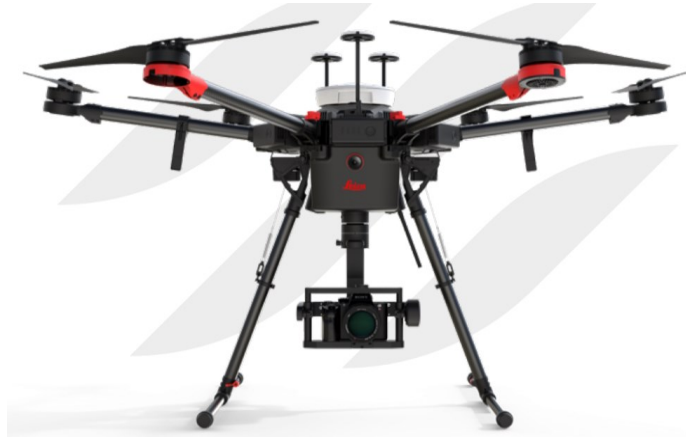
Obrázek 20: Nosič (dron) pro letecké snímkování Leica Aibot AX20 [29]
