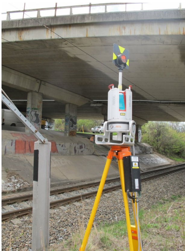
Obrázek 31: Ukázka statického pozemního skenování skenerem značky Riegl [21]
