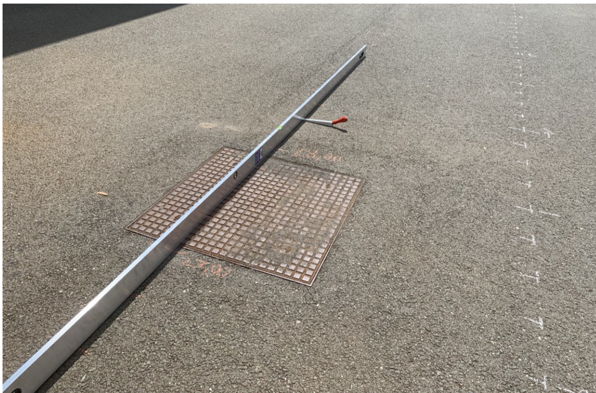
Obrázek 59: Detail poklopu šachty - měření v levé jízdni stopě, zk. úsek č. 1 [vlastní fotografie]
