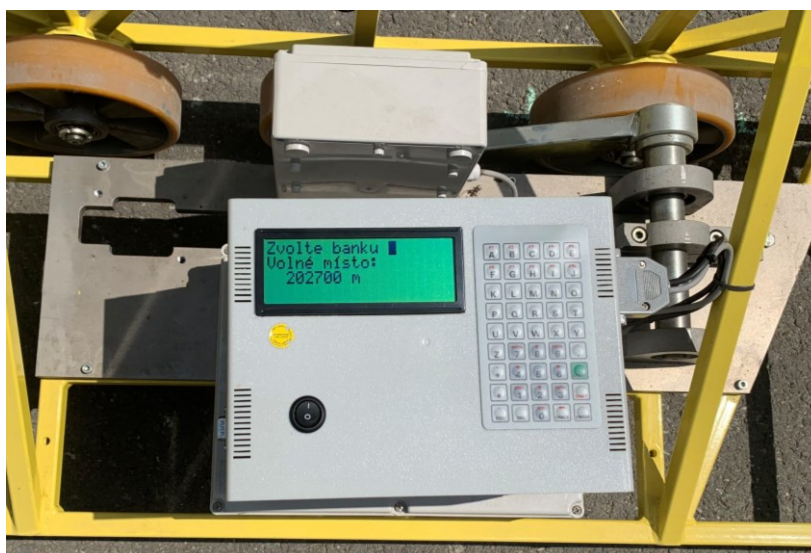
Obrázek 40: Indikační zařízení pro elektronický záznam hodnot [vlastní fotografie]
