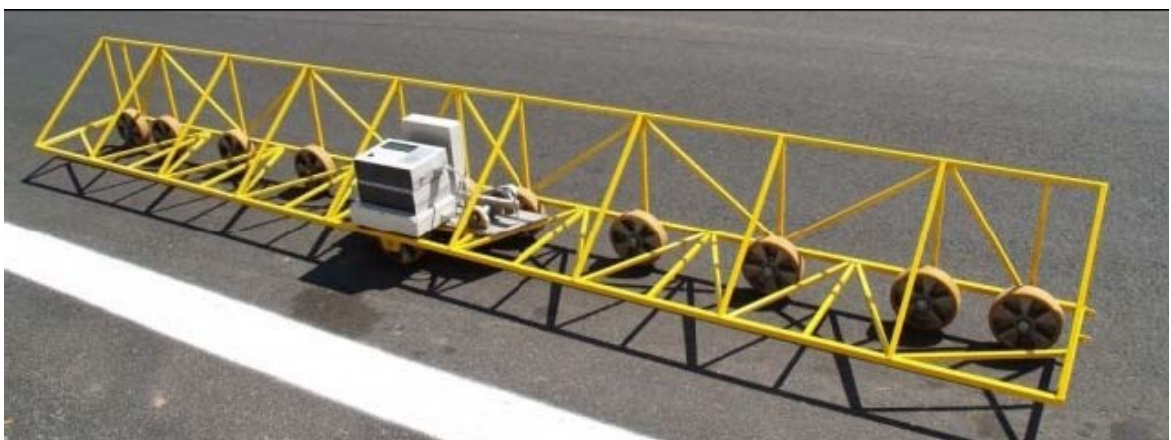
Obrázek 9: Digitální planograf s elektronickým vyhodnocováním dat [10]
