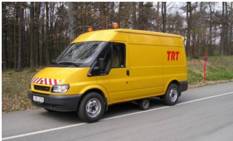
Obrázek 13: Multifunkční zařízení TRT (tatra Runway Tester) [33]
