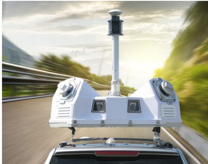
Obrázek 34: Mobilní skenovací systém Lynx HS600-D [35]
