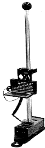
Obrázek 14: Měřicí zařízení Profilometr Dipstick [2]
