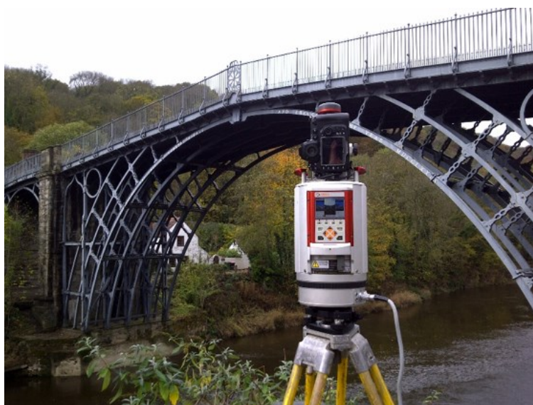
Obrázek 21: Příklad pozemního laserového skenování [32]
