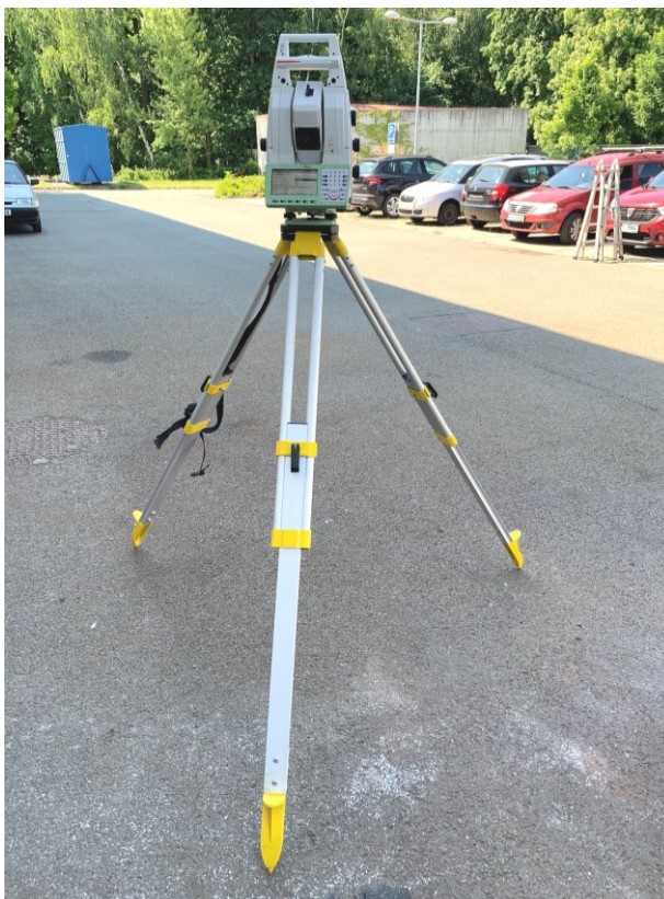
Obrázek 58: Průběh skenování multistanicí Leica MS60 – zk. úsek č. 1 [vlastní fotografie]
