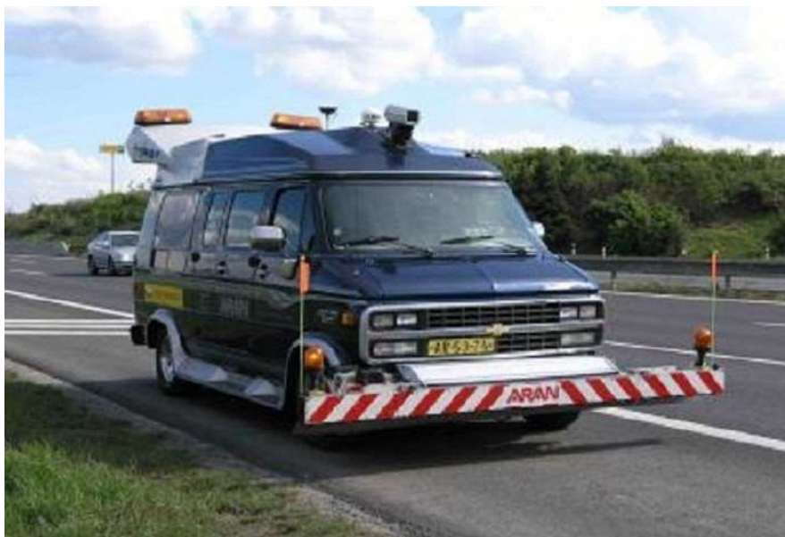
Obrázek 16: Speciální měřicí vůz ARAN [15]
