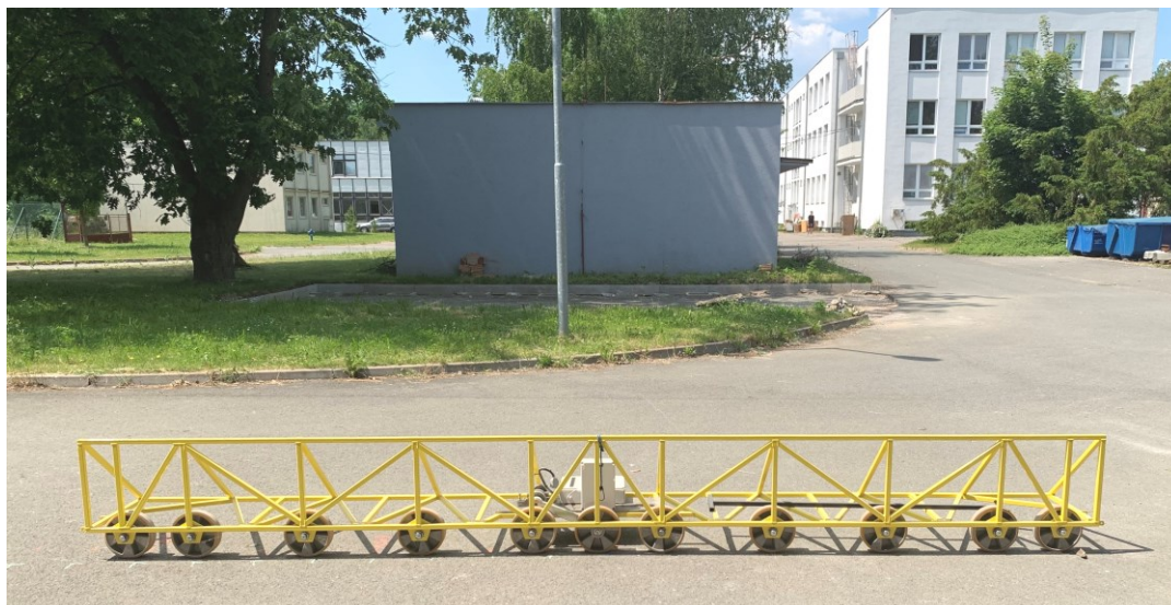
Obrázek 39: Planograf 6.705 s elektronickým vyhodnocováním [vlastní fotografie]
