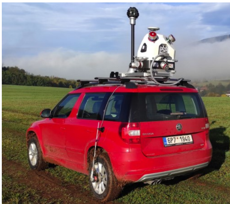
Obrázek 36: Mobilní skenovací systém Riegl VMX 2HA instalovaný na vozidle [37]
