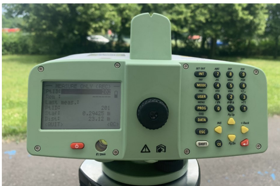
Obrázek 41: Digitální nivelační přístroj Leica DNA03 [vlastní fotografie]
