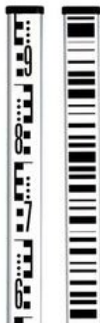
Obrázek 12: Digitální nivelační lat' s čárovým kódem a klasickou nivelační stupnicí [11]
