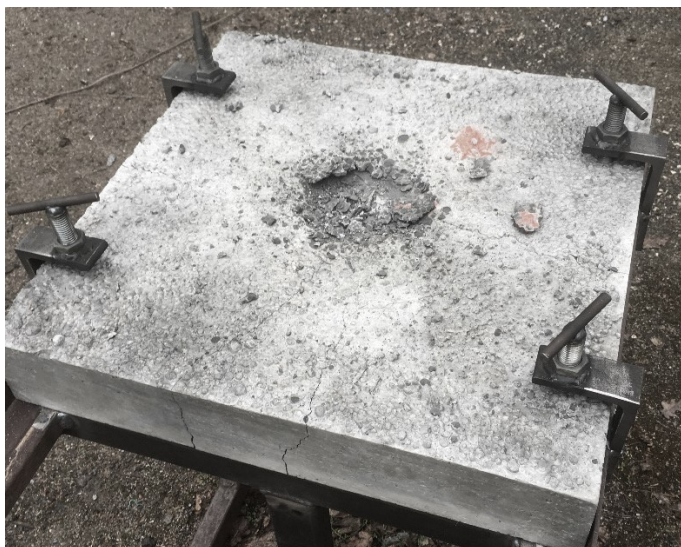
Obrázek 11 Zkušební těleso o rozměrech 600x600x100 mm [vlastní foto]
