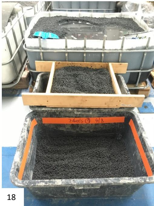
Obrázek 18 Postup přípravy nasyceného kameniva k odvozu do betonárny [vlastní foto]
