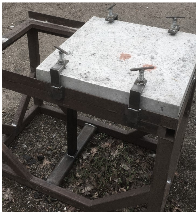
Obrázek 40 Ocelový rám pro zkoušku odolnosti LWSCC proti výbuchu [vlastní foto]
