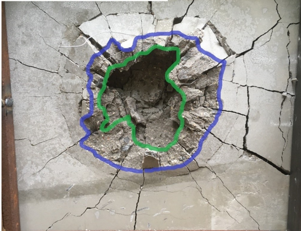
Obrázek 46 Odvrácená strana vzorku ze záměsi LWSCC 4 zatížena 100 g výbušniny [vlastní foto]
