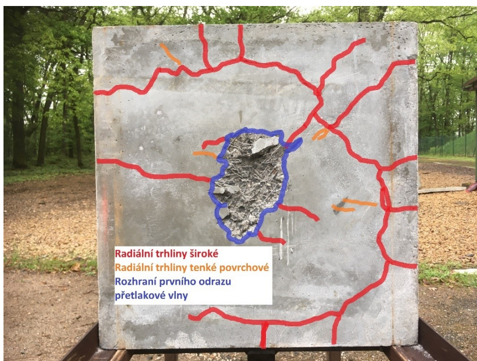
Obrázek 44 Odvrácená strana vzorku ze záměsi LWSCC 2 zatížena 50 g výbušniny [vlastní foto]
