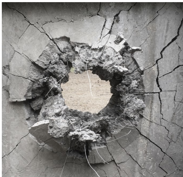
Obrázek 39 Zkouška odolnost LWSCC proti výbuchu [vlastní foto]
