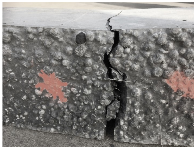
Obrázek 31 Zkouška pevnosti v tahu za ohybu vzorku 2b ze záměsi LWSCC 2 [vlastní foto]
