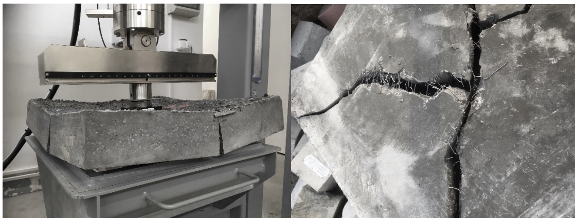
Obrázek 36 Zkouška absorbované energie zkušební desky 3a [vlastní foto]
