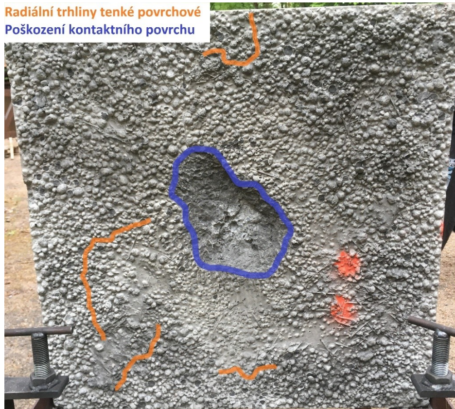
Obrázek 43 Kontaktní strana vzorku ze záměsi LWSCC 2 zatížena 50 g výbušniny [vlastní foto]
