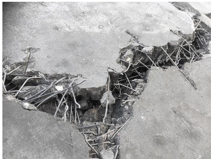
Obrázek 35 Vzorek ze záměsi LWSCC 2b [vlastní foto]
