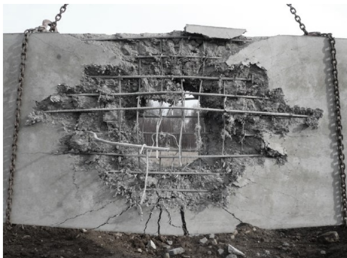
Obrázek 12 Zkušební těleso o rozměrech 300x1500x6000 mm [25]
