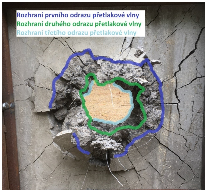
Obrázek 47 Odvrácená strana vzorku ze záměsi LWSCC 4 zatížena 150 g výbušniny [vlastní foto]
