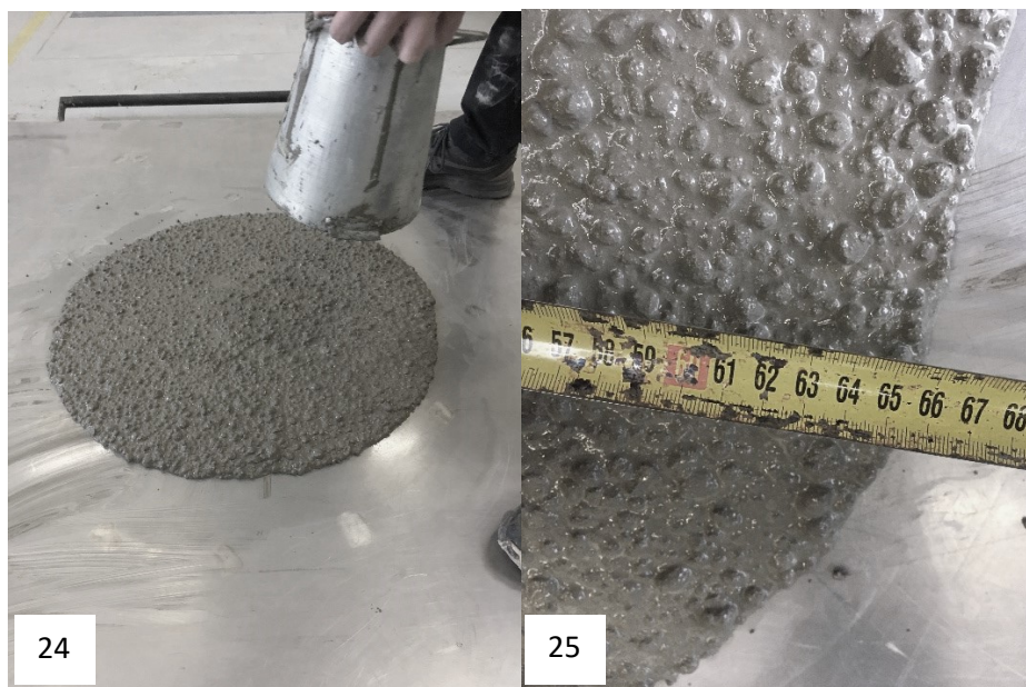
Obrázek 24 Zkouška rozlití kužele u záměsi LWSCC 1 Lab. [vlastní foto]
