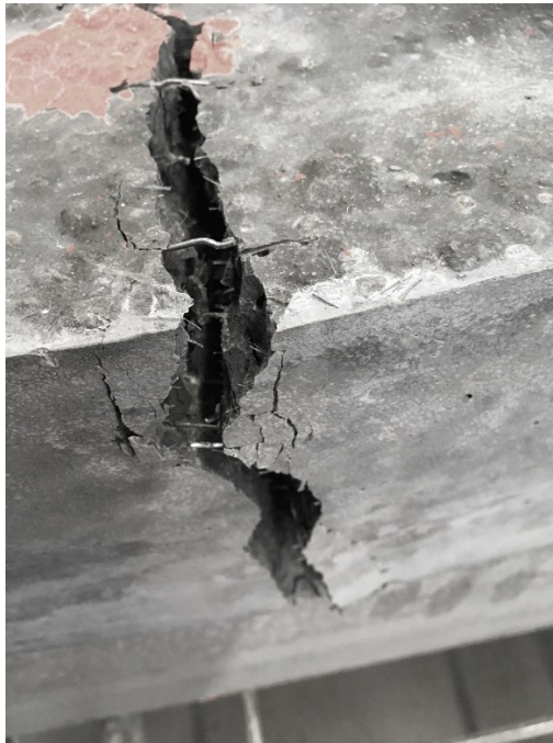
Obrázek 32 Zkouška pevnosti v tahu za ohybu vzorku 3b ze záměsi LWSCC 3 [vlastní foto]
