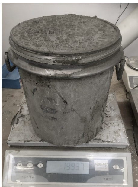
Obrázek 26 Objemová hmotnost čerstvého betonu - záměs LWSCC 1 Lab [vlastní foto]
