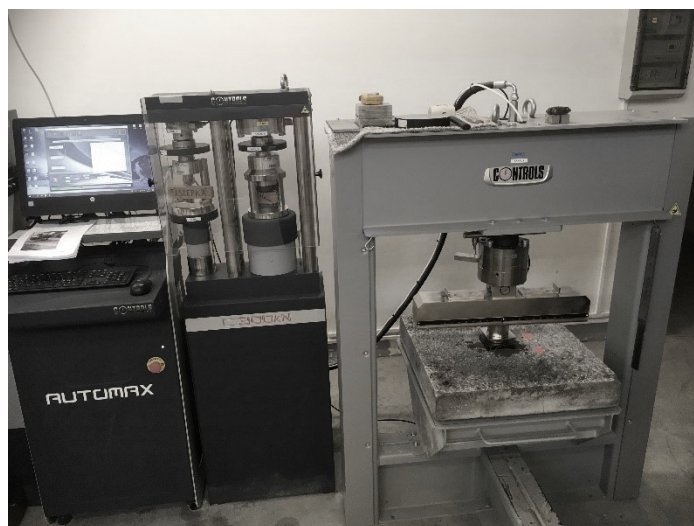
Obrázek 33 Zkušební lis Controls 50-C1201/BFR a automatická řídicí jednotka [vlastní foto]
