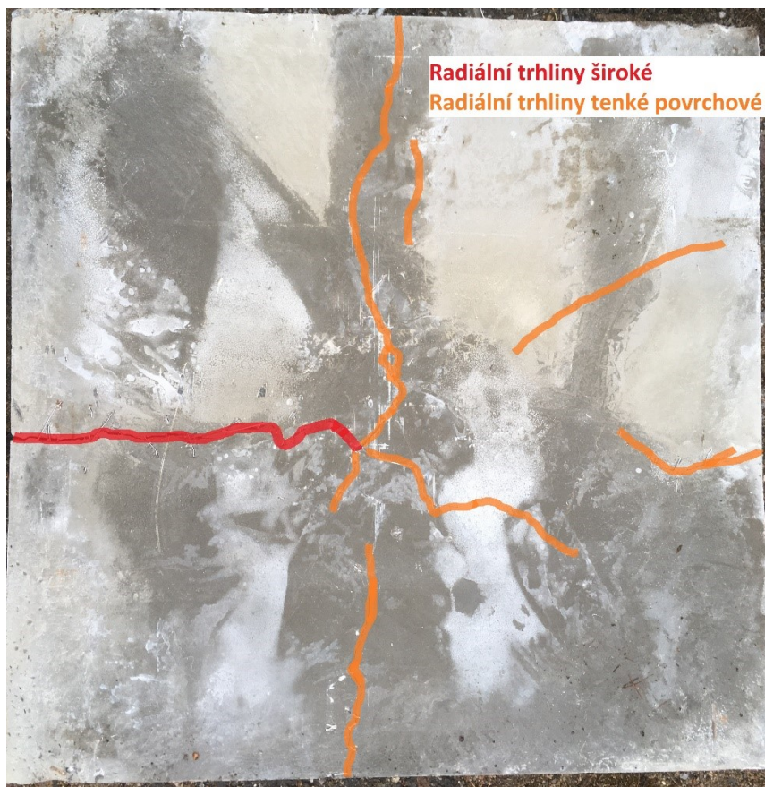
Obrázek 42 Odvrácená strana vzorku ze záměsi LWSCC 2 zatížená 25 g výbušniny [vlastní foto]
