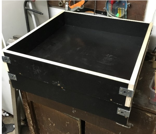
Obrázek 17 Výroba vlastních těles o rozměrech 600x600x100 mm [vlastní foto]
