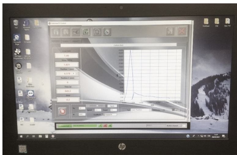
Obrázek 29 Zaznamenávání dat pomocí měřicí ústředny Controls automax [vlastní foto]
