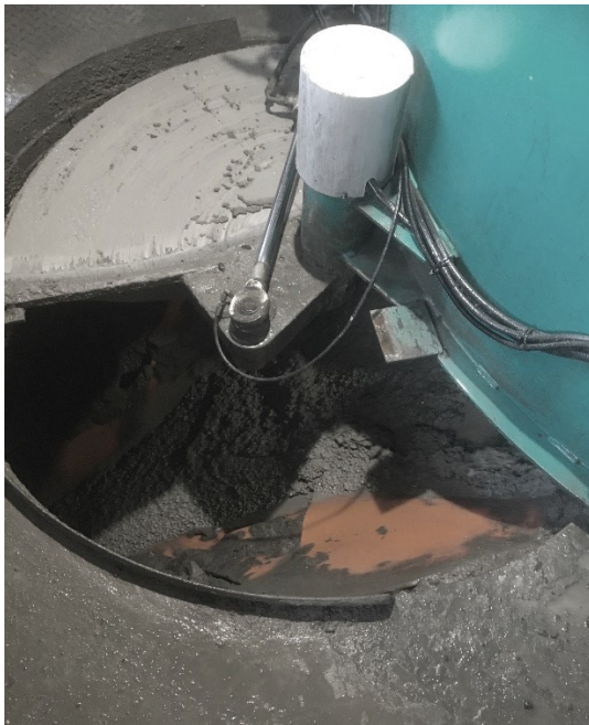
Obrázek 20 Míchání čerstvého betonu v 1 m 3 míchačce [vlastní foto]
