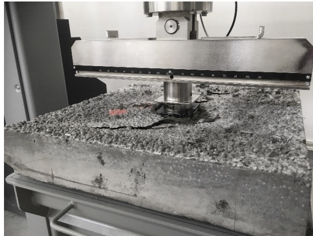
Obrázek 34 Zkouška absorbované energie ze záměsi LWSCC 2 [vlastní foto]
