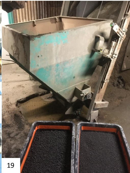
Obrázek 18 Postup přípravy nasyceného kameniva k odvozu do betonárny [vlastní foto]
