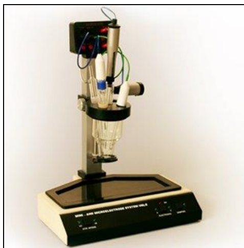
Obrázek 13 polarografický analyzátor Eco-Tribo Polarograph (Polaro-Sensors, Praha) [65]
