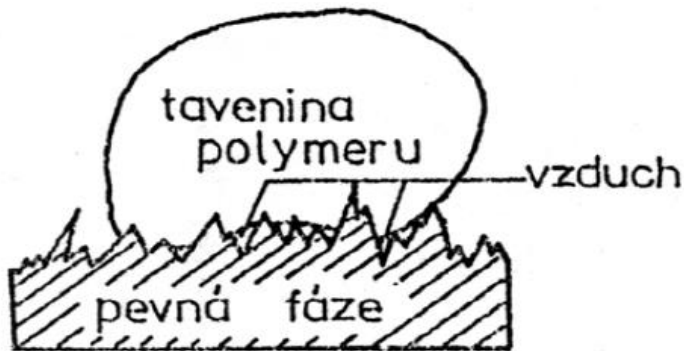
Obrázek 4 - Příklad špatného smáčení povrchu částice polymerní taveninou [12]
