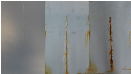
\text{Zn}_3(\text{PO}_4)_2 \cdot 2\text{H}_2\text{O} OKP = 5 %
