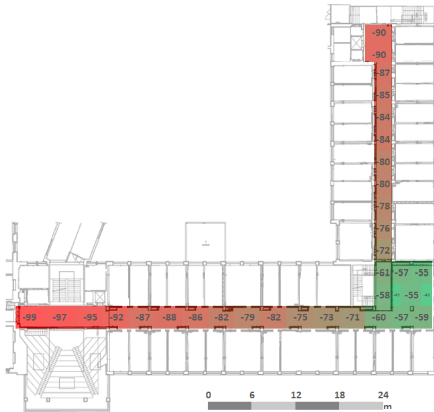
Obrázek 37 - 2 GHz Dipólová anténa 3NP (vlastní tvorba), jednotky výkonu [dBm]
