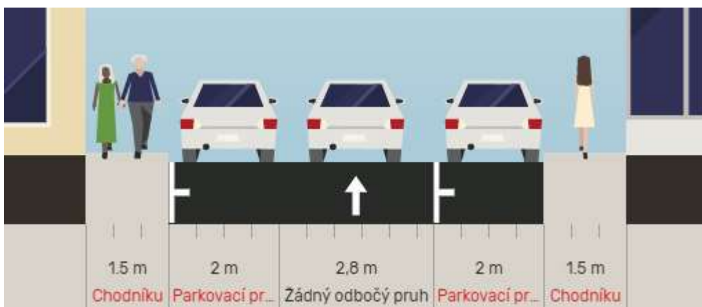
Obrázek 29 Navržená změna organizace dopravy ul. Hybešova - parkovací stání
