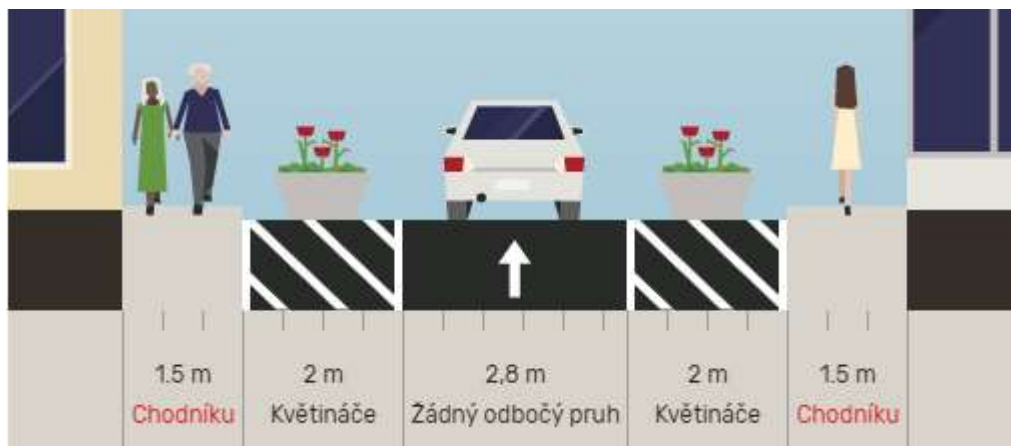
Obrázek 28 Navržená změna organizace dopravy ul. Hybešova – zeleň
