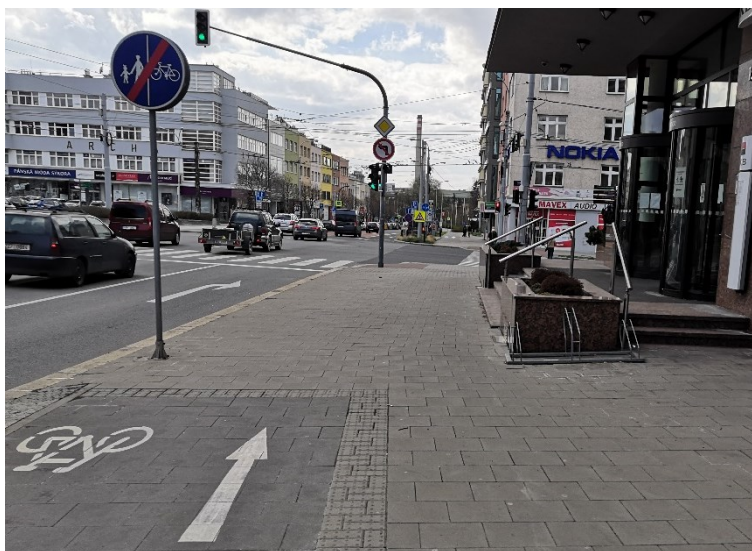
Obrázek 53: Zavádějící svislé dopravní značení
