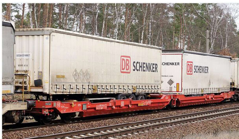
Obrázek 5 Vůz typu Sdggmrs s výměnnými nástavbami DB Schenker (21)
