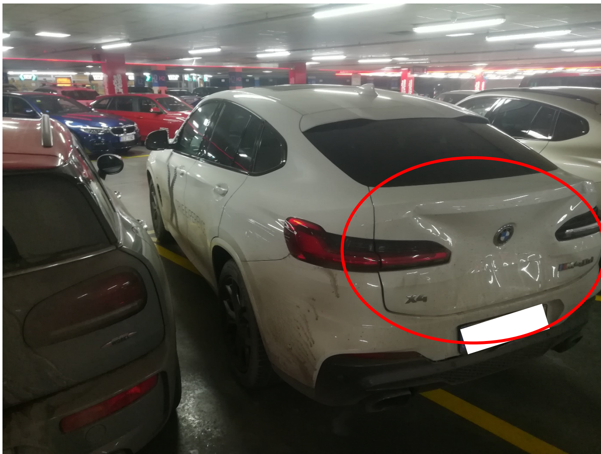
Obrázek 16 Deformace pátých dveří BMW X4 M40d
