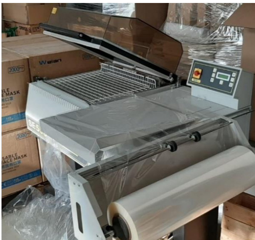
Obrázek 14 – Svářecí přístroj na fólie SE500
