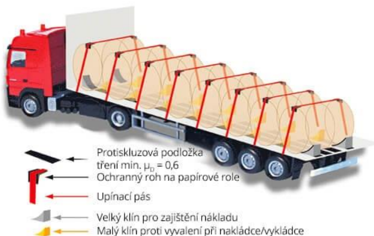
Obrázek 10 – Zajištění rolí uložených horizontálně
