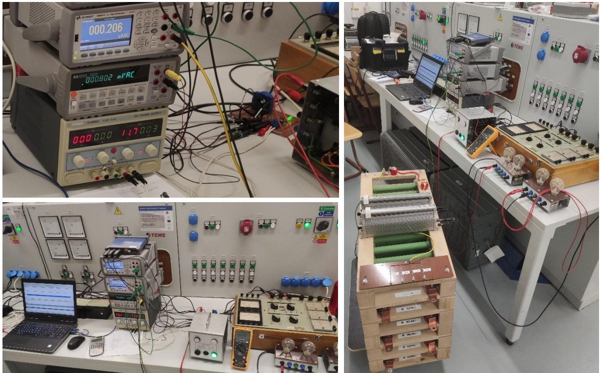
Obrázek 3.3, Pracoviště pro ověření senzoru LEM CTSR (KEEZ VVCD)
