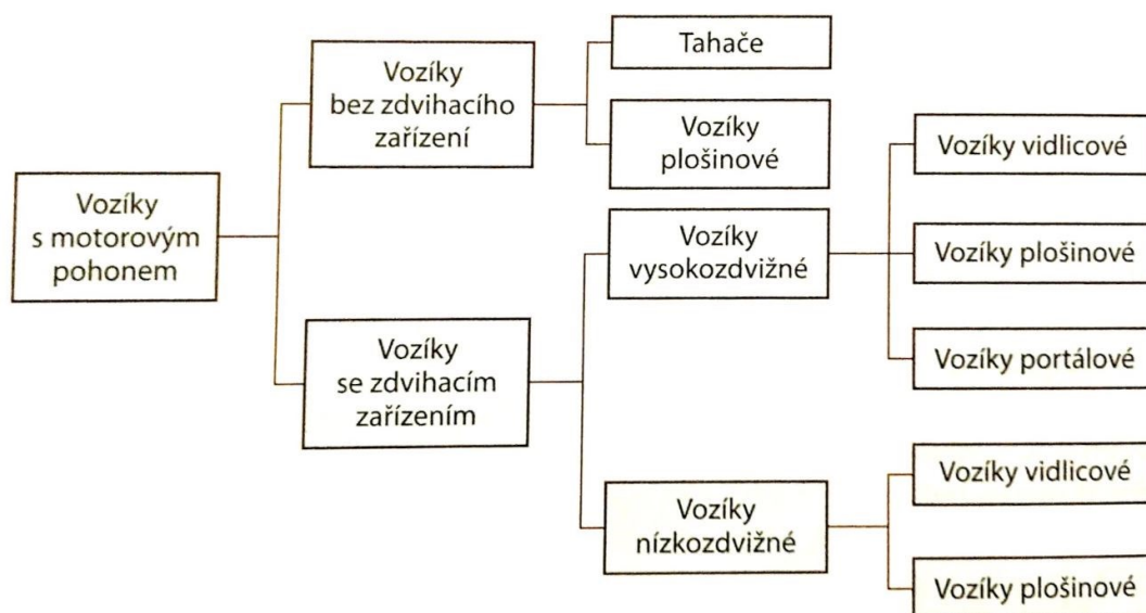
Obrázek 5 Manipulační vozíky s motorovým pohonem (Gros, Barančík a Čujan, 2016, s. 322)
