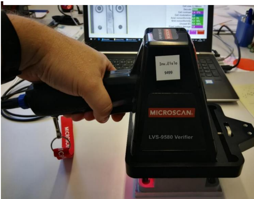
Obrázek 17 Verifikátor sloužící k ověření kvality laserového značení 2D kódu
