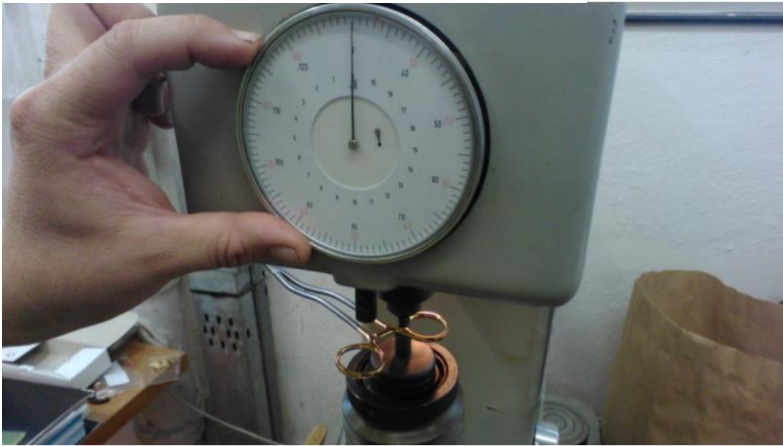
Obrázek 16 Měření tvrdosti dle Rockwella
