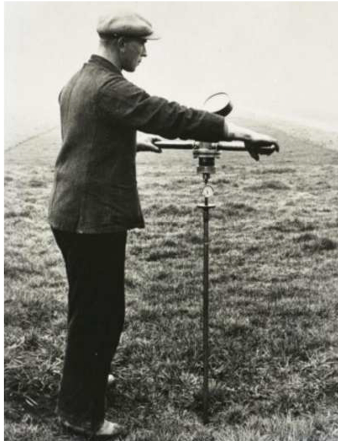
Obrázek 20. První CPT zařízení [Gouda geo-equipement]
