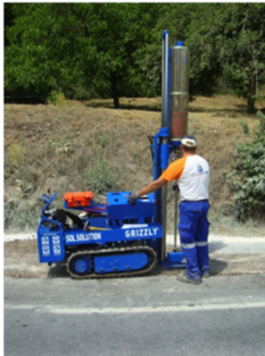
Obrázek 25. Velmi těžká penetrační souprava [InsituTest]
