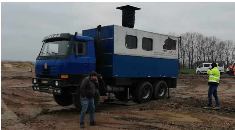
Obrázek 23. Statické penetrační soupravy typu Gouda Holland
