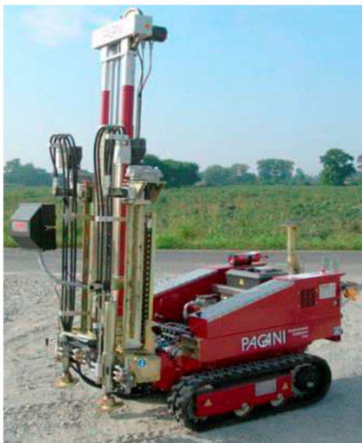
Obrázek 22. Středně těžká penetrační souprava Pagani TG 63-100 [Direct industry]
