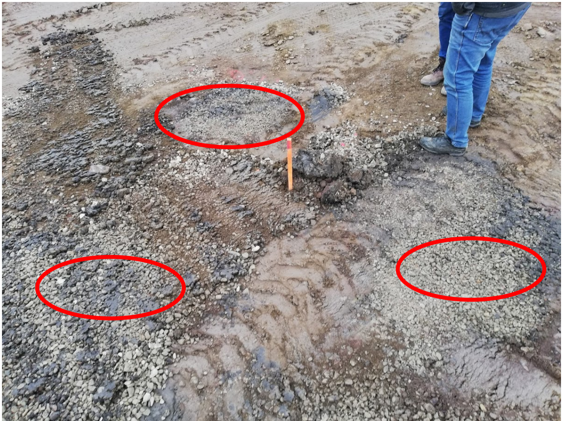
Obrázek 29. Schéma umístění sondy statické penetrační zkoušky
