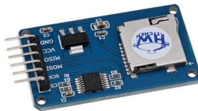
Obr. 3.5 – Čtečka microSD (Návod na použití modulu SD karty, nedatováno)
