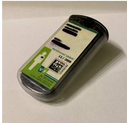
Obrázek 18 – Používaný OSL dozimetr In Light Model 2 v nemocnicích A, B, C, D, E.
