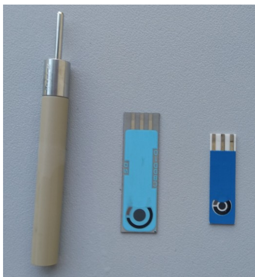
Obrázek 8 Klasická BDDE (vlevo), SP/BDD (DropSens, uprostřed), LM-SP/BDD (STU, vpravo)
