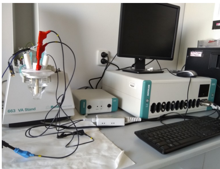
Obrázek 7 Autolab PGSTAT 30 potenciostat-galvanostat se zapojeným tříelektrodovým elektrochemickým článkem v polarografické nádobce
