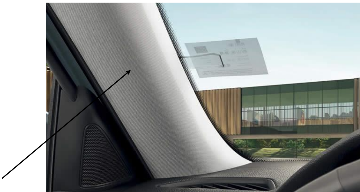
Obrázek č. 11: Horní obložení sloupku
