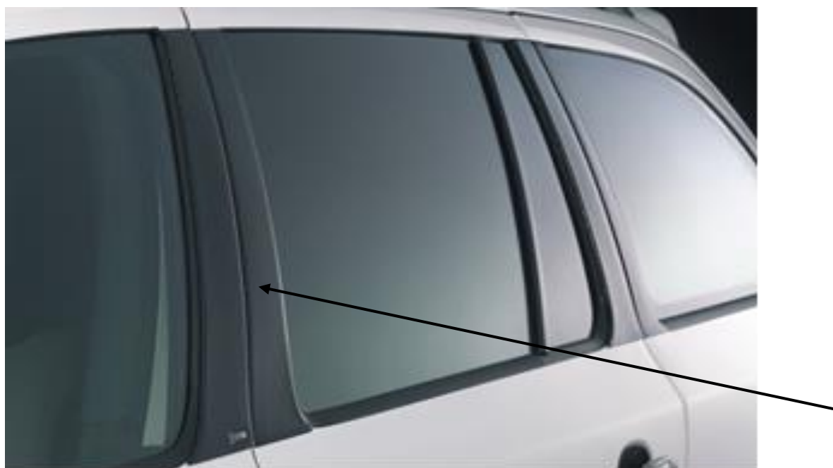
Obrázek č. 13: Exteriérové obložení sloupku
