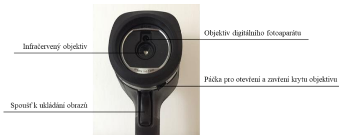
Obrázek 10 - Zadní strana termokamery FLIR E5-xt (Zdroj: vlastní zpracování)
