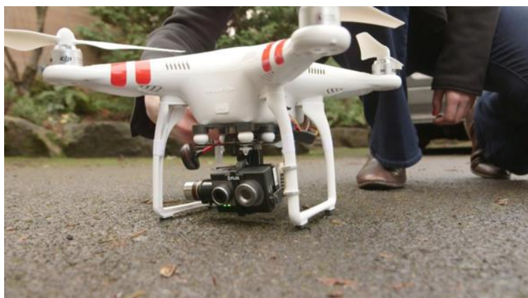
Obrázek 8 - Umístění termokamery FLIR DUO na dron (Zdroj: (Eshop.pro-drony.cz, 2016))
