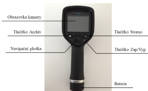
Obrázek 9 - Přední strana termokamery FLIR E5-xt (Zdroj: vlastní zpracování)
