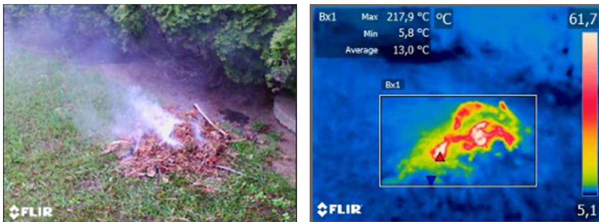
Obrázek 70 - Doutnající kupa listí v režimu digitálním a IČ v zobrazení "Rainbow" (Zdroj: vlastní zpracování)
