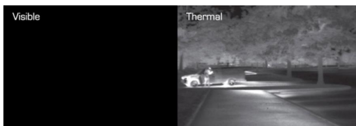
Obrázek 4 - Bezpečnostní termokamera FLIR řady FC - porovnání se standardní kamerou (Zdroj: (Termokamery-flir.cz, 2017))
