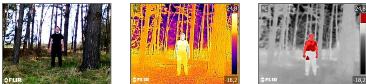
Obrázek 30 - Snímek osoby v režimu digitálním, MSX a "Alarm nad" ze vzdálenosti 5 m (Zdroj: vlastní zpracování)
