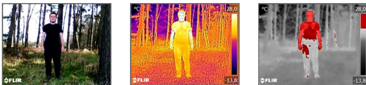
Obrázek 29 - Snímek osoby v režimu digitálním, MSX a "Alarm nad" ze vzdálenosti 3 m (Zdroj: vlastní zpracování)
